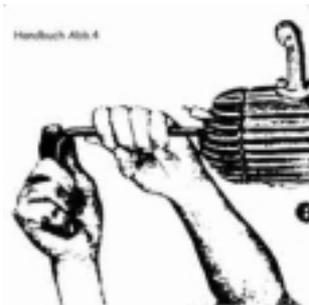
werden die vier Schrauben aus dem Zylinderkopf herausgeschraubt und samt den Unterlogen abgenommen. Falls sich der Zylinderkopf nicht leicht vom Zylinder abnehmen lässt, muss er durch Beklopfen mit einem Holzhammer oder durch Stemmen mit zwei Schraubenziehern gelockert werden (Abb. 5). Vorher muss jedoch der Kolben in den unteren Totpunkt gebracht werden.
